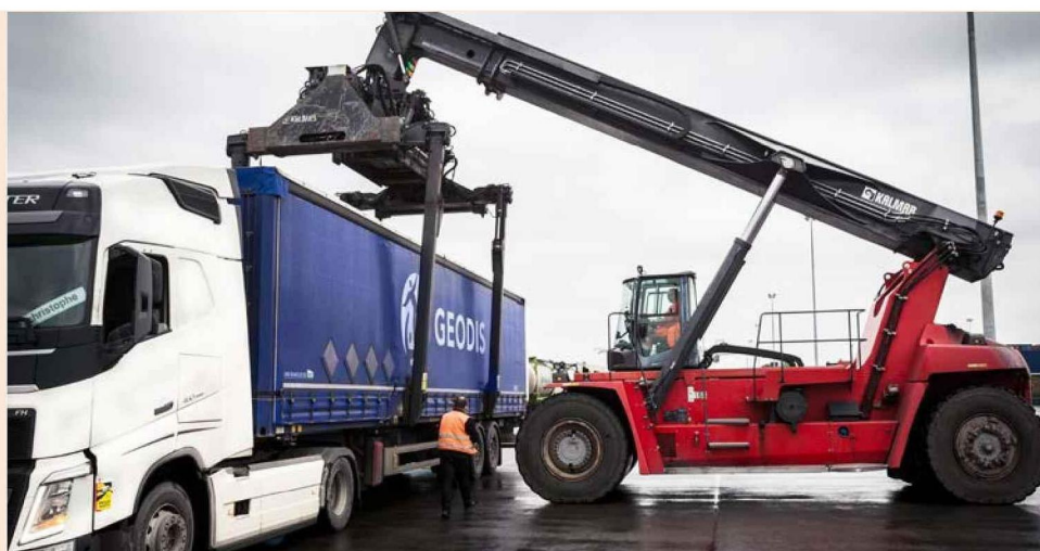
Chaque caisse mobile Geodis transporte 33 palettes de produits Naos, soit 15 tonnes de marchandises sécurisées de bout en bout sans rupture de charge.
